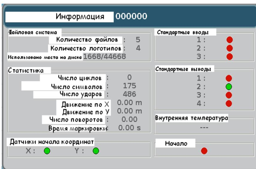
О состоянии разных сенсоров Вы можете узнавать по загоранию светодиодных лампочек, которые меняет цвет с зеленого на красный в соответствии с состоянием датчиков.
